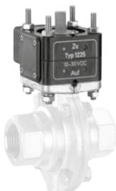
Датчик положения GEMÜ 1225 предназначен для установки на поворотной арматуре типового ряда затворов GEMÜ DN 15–50 мм из ПВХ, латуни и нержавеющей стали. Наряду с электрической сигнализацией конечных положений с помощью выключателей устройство оснащено в серийном оснащении визуальной индикацией положений на основе светодиодов.
