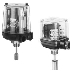
Электрические датчики положения GEMÜ 1214 и 1232 имеют один или два датчика приближения для сигнализации конечного положения. Они регулируются механически. GEMÜ 1214 пригоден для монтажа на линейных приводах с макс. ходом 70 мм. GEMÜ 1232 пригоден для монтажа на линейных приводах с макс. ходом 20 мм.
