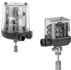
Электрические датчики положения GEMÜ 1211 и 1231 имеют один или два датчика приближения для сигнализации конечного положения. Они регулируются механически. Устройства пригодны для установки во взрывозащищенных приложениях согласно ATEX. GEMÜ 1211 пригоден для монтажа на линейных приводах с макс. ходом 70 мм. GEMÜ 1231 пригоден для монтажа на линейных приводах с макс. ходом 20 мм.
