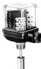
Электрический датчик положения GEMÜ 1230 имеет один или два микровыключателя для сигнализации конечных положений. Они регулируются механически. GEMÜ 1230 пригоден для монтажа на линейных приводах с макс. ходом 20 мм.
