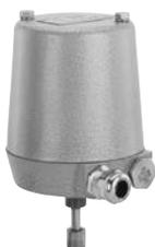
Электрический датчик положения GEMÜ 1205 имеет один или два микровыключателя для сигнализации конечных положений. Они регулируются механически. Устройство пригодно для установки во взрывозащищенных приложениях согласно ATEX. GEMÜ 1205 пригоден для монтажа на линейных приводах с макс. ходом 70 мм.
