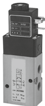
GEMÜ 8505 4/2-ходовый вспомогательный управляющий клапан с серво- управлением из алюминия DN 4 + 7 (1,0/1,5–10 бар)
